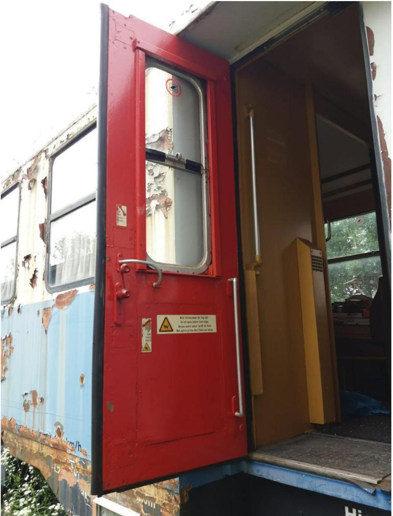
Der Aufbau und das Fahrwerk weisen keine Rostschäden auf. Die Lackierung muß jedoch grundlegend erneuert werden.
